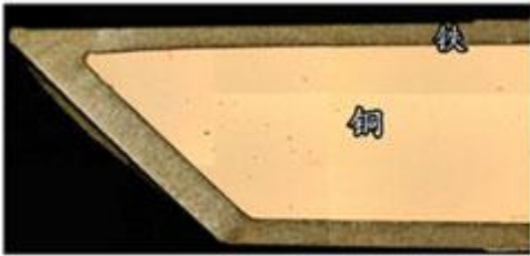
(图3) 新焊咀横切面图
