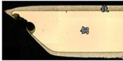
(图4) 侵蚀焊咀横切面图
